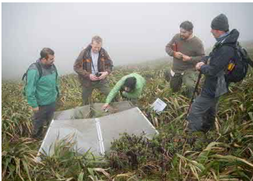
Experimento de cámara abierta de calentamiento en el sitio piloto Cajanuma. Parque Nacional Podocarpus, Ecuador. Fotografía: Leire Ruiz
