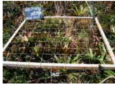
Figura 9. a) Malla de madera ubicada directamente en el suelo cuando la vegetación fue pequeña; b) malla ubicada a una altura máxima de 0,5 m con respecto al suelo, cuando la vegetación fue más alta.
